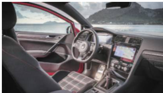
Proposée en option, la boîte à double embrayage DSG affiche sept rapports, un de plus que la version à boîte manuelle. La position de conduite remarquable s'appuie sur une grande amplitude de réglages du siège et du volant à méplat. VOLKSWAGEN AG
